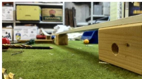
diese mitschwingen, wenn eine Kugel runterrollt. Dies hatte zur Folge, dass die Bahnform sehr von der theoretischen, über die Befestigungen geplanten, Form abweicht und somit Berechnungen mit dieser Bahn nicht verlässlich überprüft werden konnten. Wir experimentierten während eines Großteils unserer Versuchszeit mit dieser Bahn, konnten das Problem jedoch nur unzureichend über zusätzliche Befestigungen lösen. Dies veranlasste uns letztendlich zum aufwändigeren Bau einer festen Bahn.
