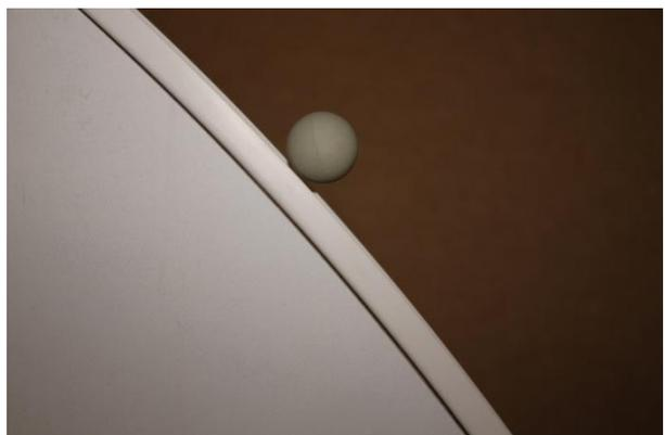
Als Grund für diese Abweichungen vermuten wir, dass die Kugel nur dann weitere Rotationsenergie aufnimmt, wenn sie stark genug auf den Untergrund gepresst wird. Wird sie nicht stark genug angepresst, erhöht sich bei der weiteren Bewegung nur noch ihre Translationsenergie. Die Kugel wird dadurch stärker beschleunigt und hebt früher ab.
