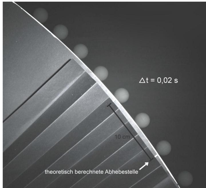
Bei einer großflächigeren Aufnahme mit höherer Stroboskopfrequenz war das Abheben der Kugel noch deutlicher zu erkennen. Der weiße Strich markiert die theoretisch berechnete Abhebestelle.
